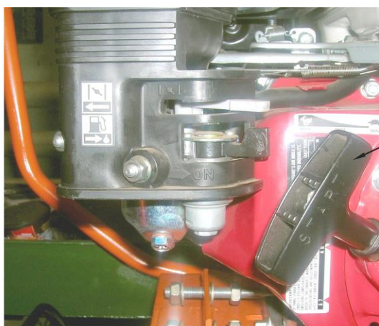
Рисунок 8. Запуск двигателя при помощи рукоятки стартера
