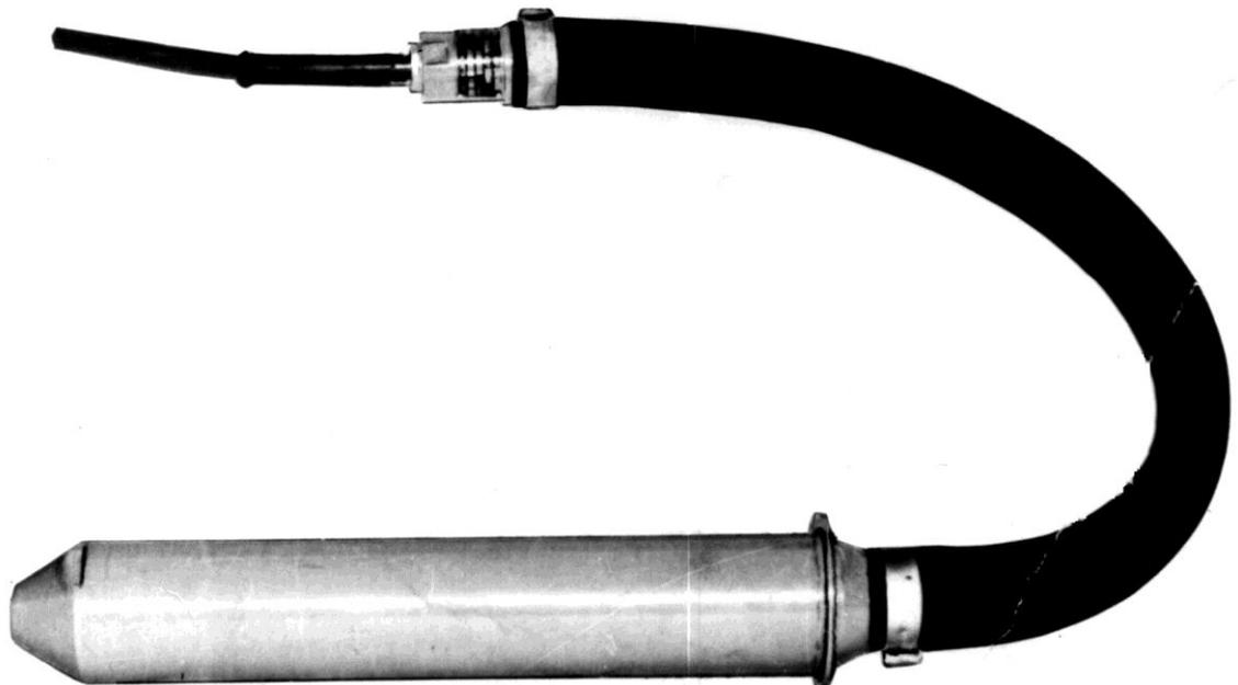
Рисунок 1. Вибратор электрический глубинный подвесной ИВ – 95А.
