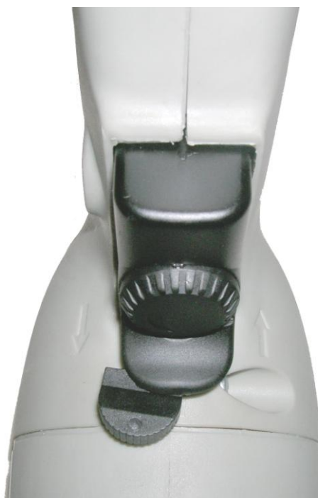
Рисунок 2. Положение переключателя направления вращения (реверс)
