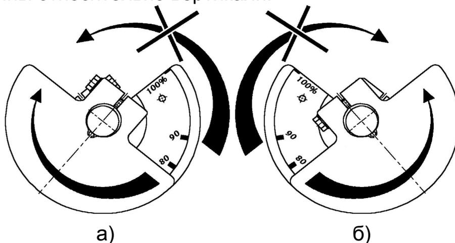
**Рисунок 3. Схема регулировки статического момента дебалансов:**
