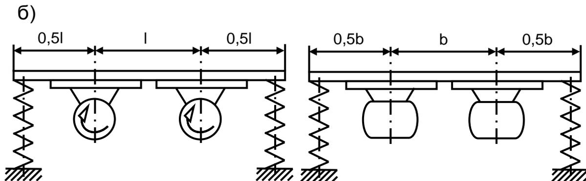
В случаях, когда техпроцесс требует направленных колебаний системы (прямолинейное транспортирование, ориентирование, забивание, трамбование и т.п.), одностипные вибраторы устанавливаются парами на одной опорной плите с параллельными противоположно вращающимися валами:
