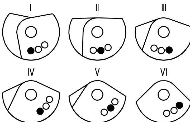
**Рисунок 4. Схема регулировки статического момента дебалансов вибратора ИВ–05-16.**
