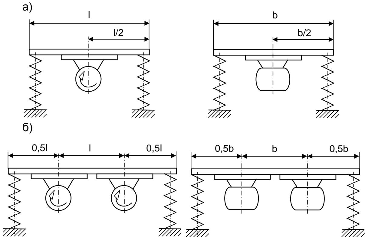
В случаях, когда техпроцесс требует направленных колебаний системы (прямолинейное транспортирование, ориентирование, забивание, трамбование и т.п.), однотипные вибраторы устанавливаются парами на одной опорной плите с параллельными противоположно вращающимися валами.
